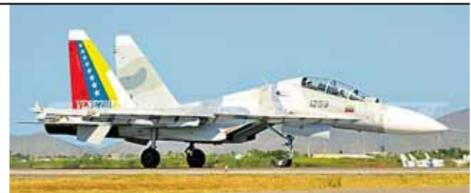
– многофункциональный истребитель с широкими боевыми возможностями. Он способен с высокой эффективностью поражать воздушные, наземные и морские цели. Вооружение самолета включает встроенную автоматическую скорострельную одноствольную пушку калибра 30 миллиметров типа ГШ-301 с боекомплектом 150 снарядов и ракетно-бомбовое вооружение, размещаемое на 12 точках подвески под крылом и фюзеляжем.
